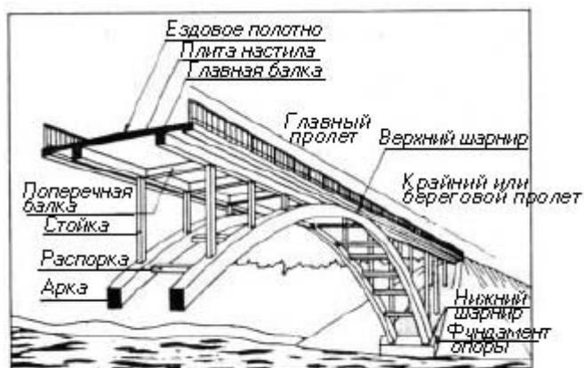
Рисунок 16. Железобетонный арочный мост.
