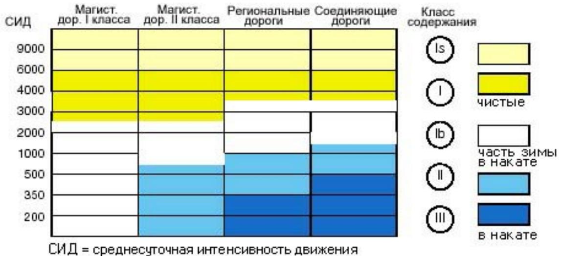
Рисунок 6. Классы содержания дорог общего пользования.
