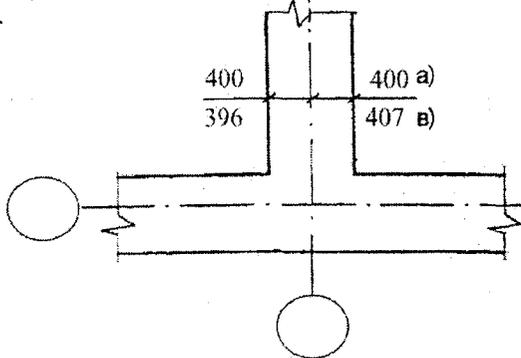
а) размер от грани монолитного ростверка до оси;
