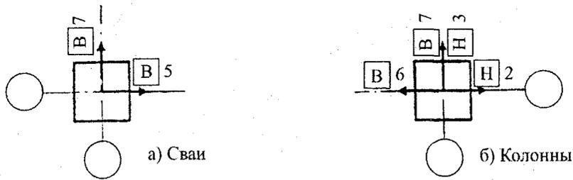
Примечание – Примеры указания фактических отклонений осей элементов от разбивочных осей. На плане перед числовыми значениями отклонений помещаются в прямоугольной рамке буква «В» для верхнего сечения или «Н» – для нижнего сечения элемента.
