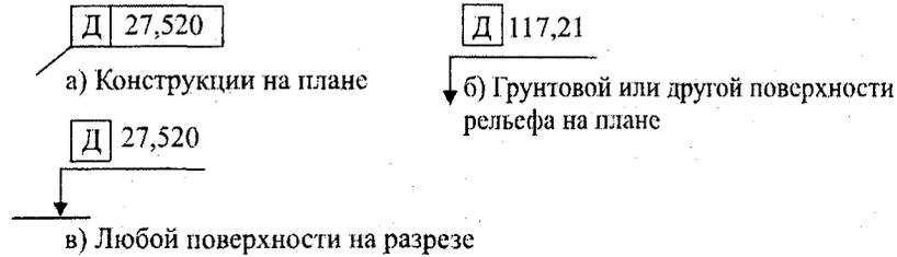
Обозначение действительной отметки поверхности (Д)
