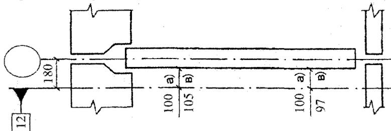
а) размер от грани стеновых панелей до оси;
