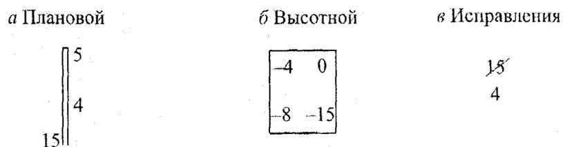
Примеры указаний действительных отклонений панелей в нижних сечениях и плит перекрытий от наивысшей точки монтажного горизонта:
