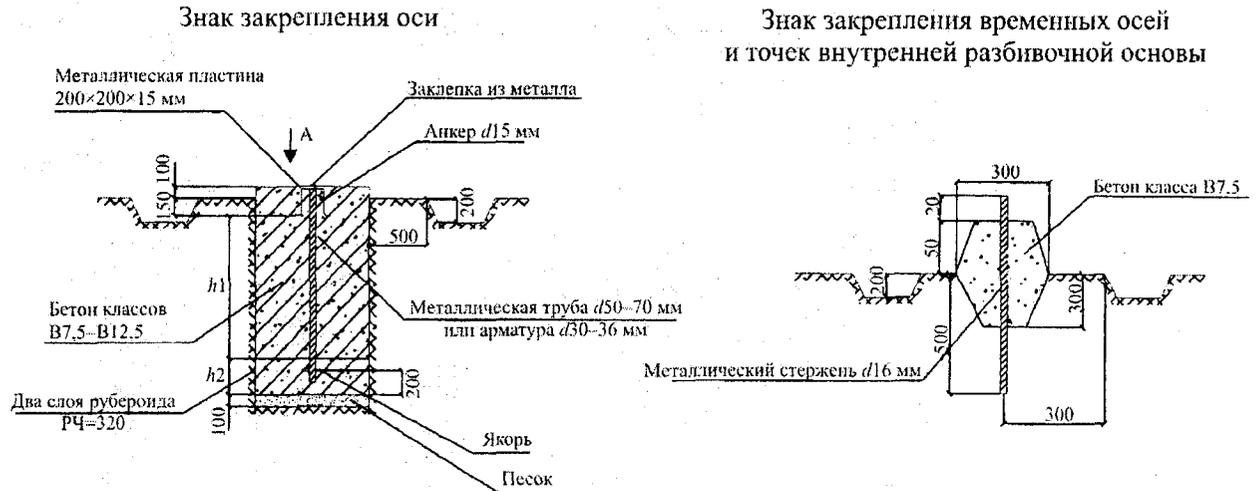
$h_1$  – соответствует наибольшей глубине промерзания грунта
