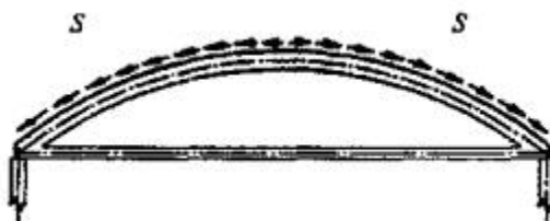
Рисунок 9.9 - Схема передачи усилий с оболочки на диафрагму
