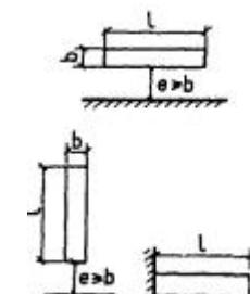
В табл. 2  $l = l/b$ , где  $l$ ,  $b$  – соответственно максимальные размеры сооружения или его элемента в плоскости, перпендикулярной направлению ветра
