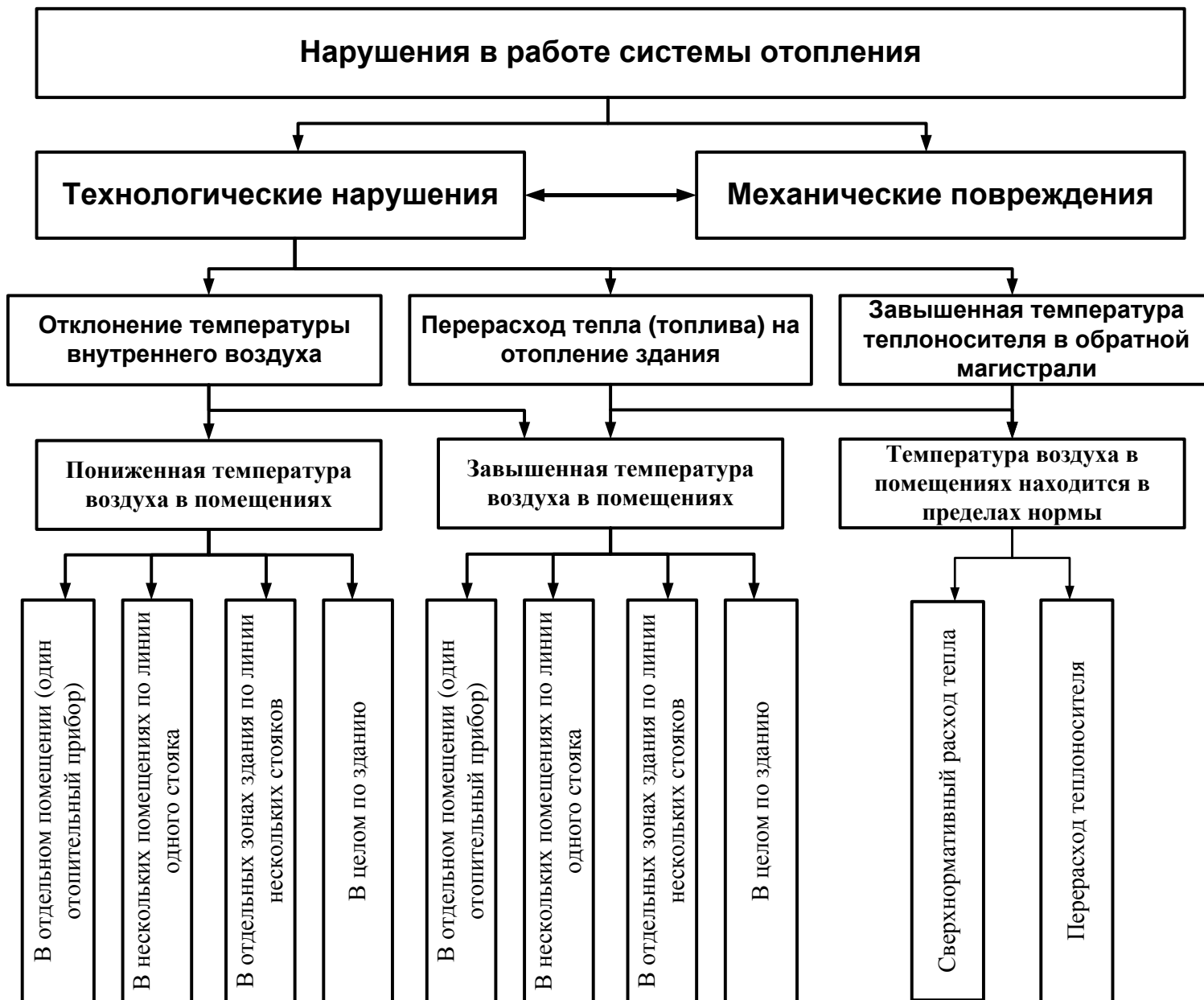
Рис. 5.1. Схема нарушений в работе системы отопления
