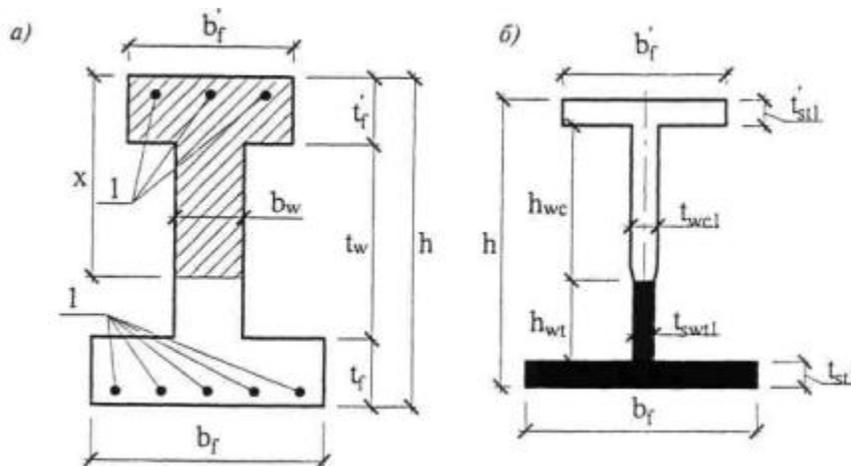
а - сечение сталефибробетонного элемента, б - сечение, приведенное к стальному;  $\phi$  - стержневая арматура
