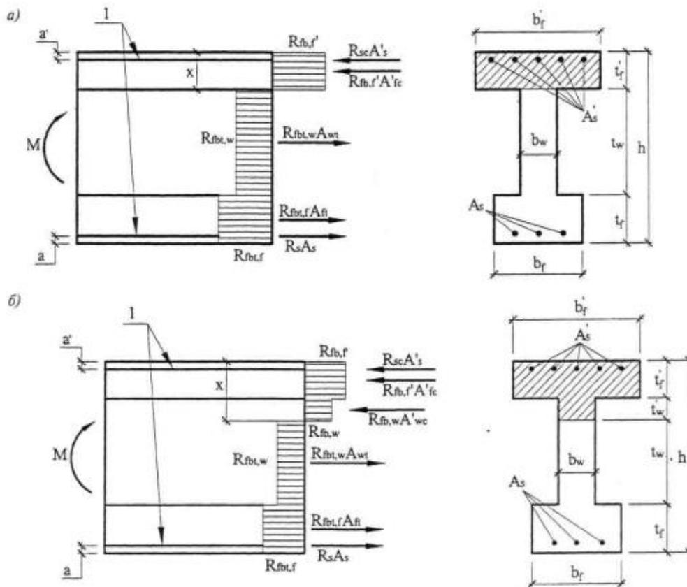
а – при  $x \leq x_f'$ ; б – при  $x > x_f'$ ; 1 – стержневая арматура
