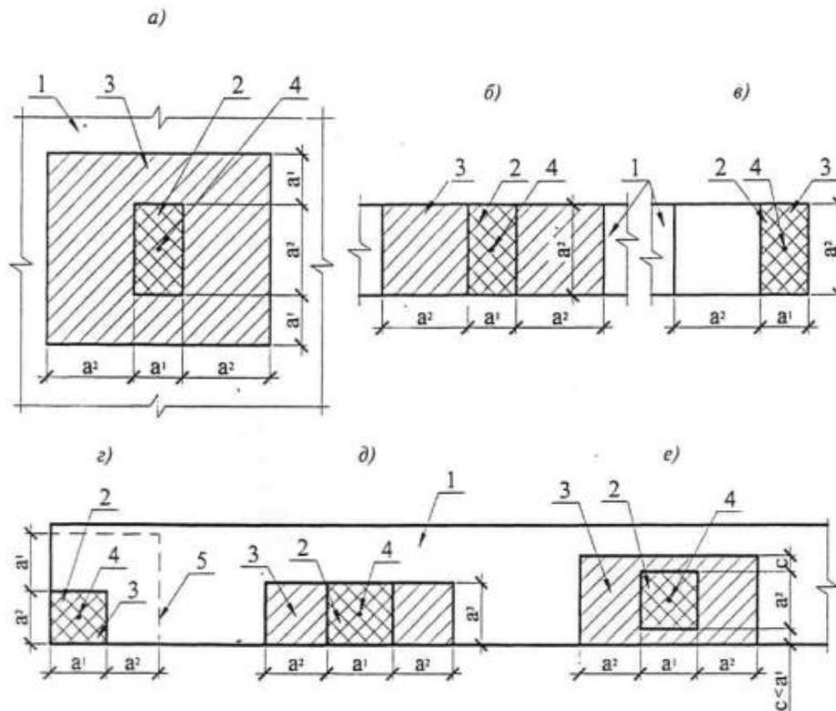
а - вдали от краев элемента; б - по всей ширине элемента; в - у края (торца) элемента по всей его ширине; г - на углу элемента; д - у одного края элемента; е - вблизи одного края элемента; 1 - элемент, на который действует местная нагрузка; 2 - площадь смятия  $A_{fb,loc}$ ; 3 - максимальная расчетная площадь  $A_{fb,max}$ ; 4 - центр тяжести площадей  $A_{fb,loc}$  и  $A_{fb,max}$ ; 5 - минимальная зона армирования сетками, при которой косвенное армирование учитывается в расчете
