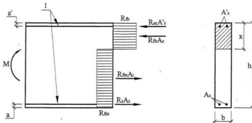
**Рисунок 6.2 - Схема усилий и эпюра напряжений в сечении, нормальном к продольной оси изгибаемого сталефибробетонного элемента прямоугольного сечения, при его расчете по прочности (при комбинированном армировании)**
