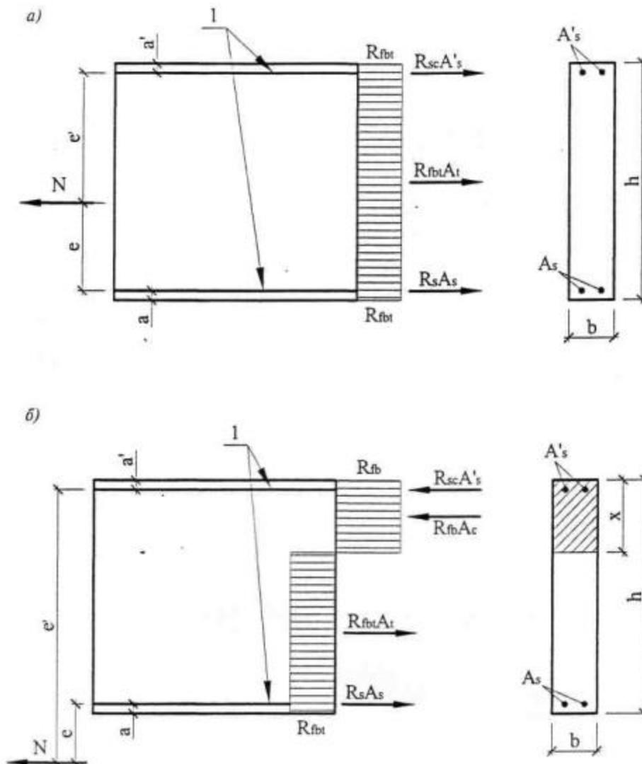
**а – между равнодействующими усилий в арматуре  $S$  и  $S'$ ; б- за пределами расстояния между равнодействующими усилий в арматуре  $S$  и  $S'$ ; 1 – стержневая арматура**
