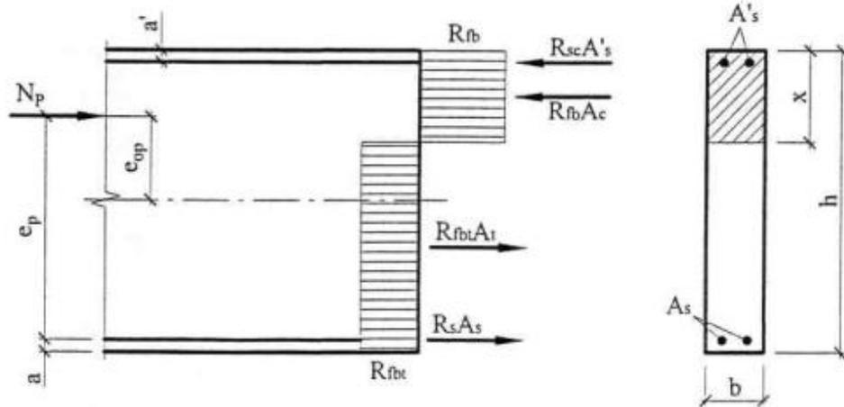
**Рисунок 6.7 - Схема усилий и эпюра напряжений в сечении, нормальном к продольной оси изгибаемого предварительно напряженного сталефибробетонного элемента при его расчете по прочности в стадии обжатия**
