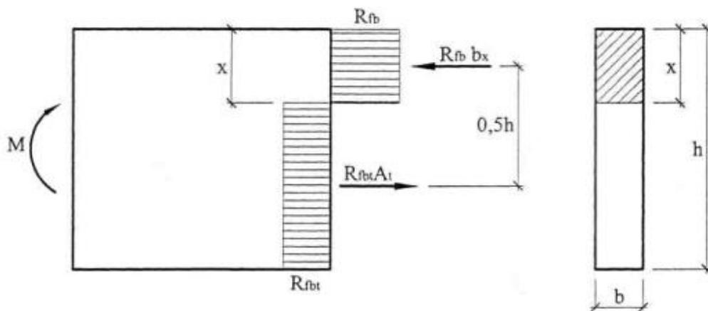
**Рисунок 6.1 - Схема усилий и эпюра напряжений в сечении, нормальном к продольной оси изгибаемого сталефибробетонного элемента прямоугольного сечения, при его расчете по прочности (при фибровом армировании)**
