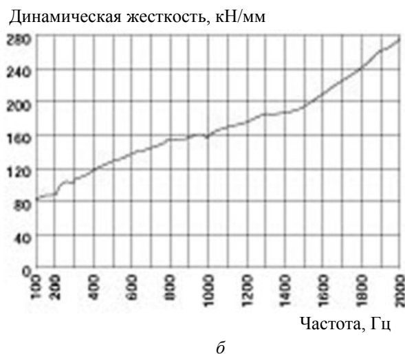
Рис. 1.11. Статический (а) и динамический (б) коэффициенты упругости подрельсовой прокладки из материала SYLODYN фирмы «Getzner»
