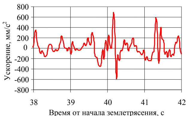
Рис. 5.22. Фрагмент интенсивной части акселерограммы камчатского землетрясения (24.11.1971 г.)
