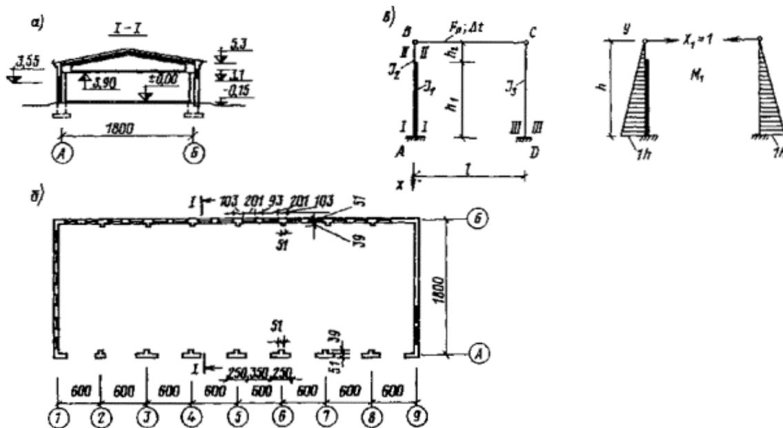
Черт. 14. К расчету температурных усилий в стенах и перекрытии одноэтажного промышленного здания
