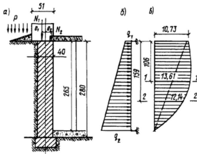
Черт. 57. Расчет стены подвала
