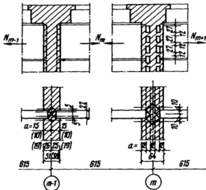
Черт. 12. К расчету кладка поперечных стен в местах заделки плит перекрытий
