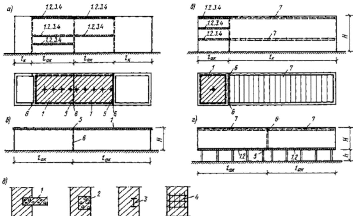
Черт. 60. Примеры устройства температурных швов в стенах каменных зданий с армированными включениями (перекрытия, балки, армированные пояса)
