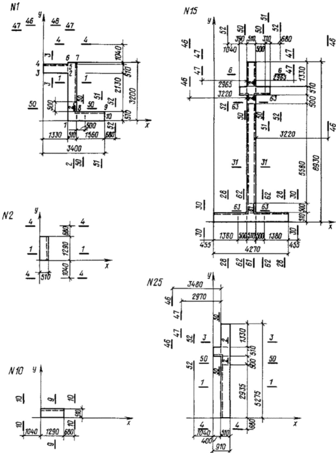
Черт. 11. Геометрические размеры горизонтальных сечений рассматриваемых элементов
