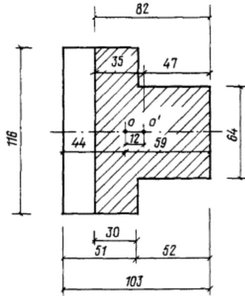
Перекрытие сборное железобетонное, заделанное на опорах в кладку стены, толщина перекрытия  $H_f = 0,22$  м.
