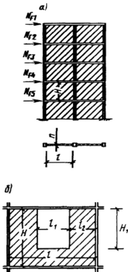
Черт. 19. К расчету каркасных стен
