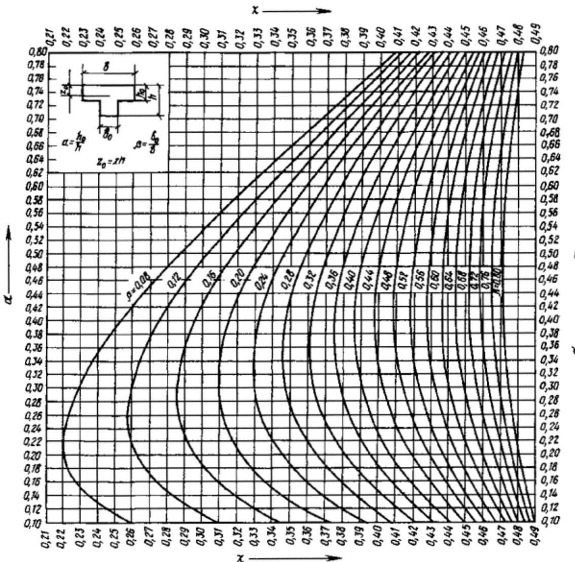
Б. ГРАФИК ДЛЯ ОПРЕДЕЛЕНИЯ МОМЕНТОВ ИНЕРЦИИ
