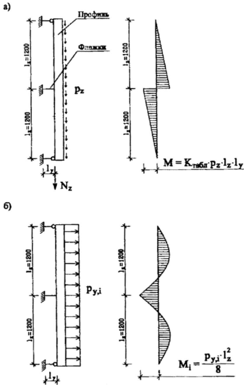
Рис. 6.3. Расчетные схемы вертикального профиля
