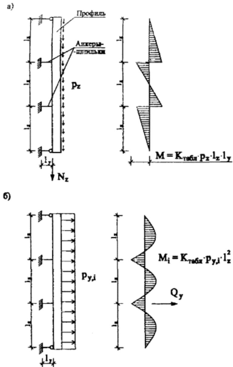
Рис. 6.1. Расчетные схемы вертикального профиля
