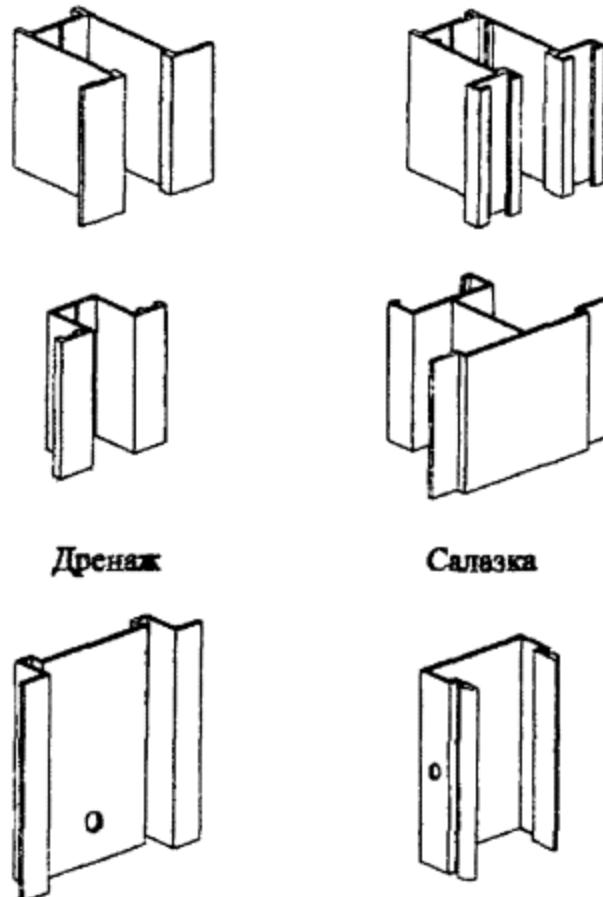
Рис. 3.14. Система "U-KON", виды вертикальных профилей, дренаж и салазки
