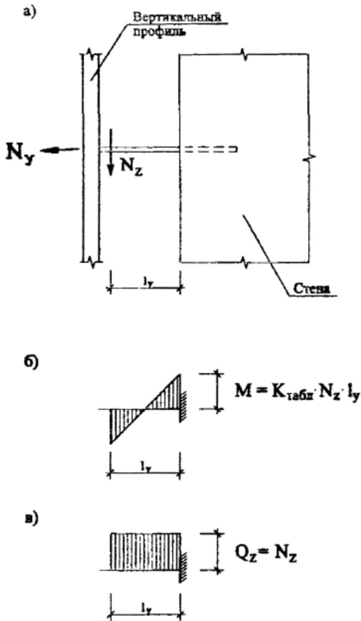
Рис. 6.2. Расчетная схема анкера-шпильки
