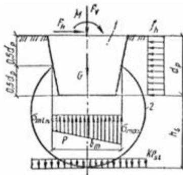
**Рис. 54. Схема к расчету столбчатого фундамента
