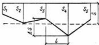
Рис. 6. Схема осадок основания сооружения.
