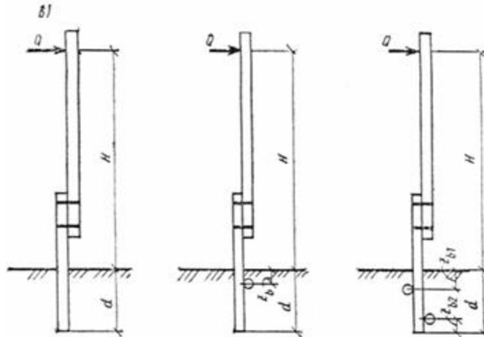
**Рис. 85. Схемы к расчету стоек деревянных опор в грунте**
