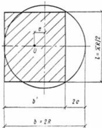
**Рис. 28. Схема для определения приведенных размеров круглого фундамента**
