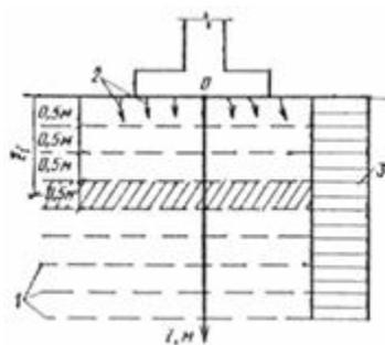
**Рис. 71. Схема для расчета расселения однородного основания при вертикальной фильтрации**
