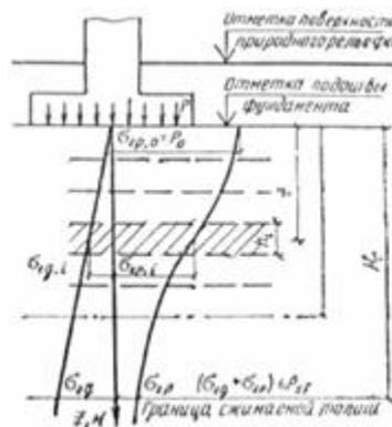
**Рис. 72. Схема для расчета деформаций при вертикальной фильтрации**
