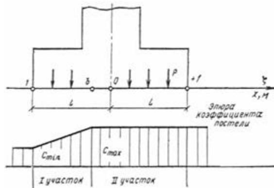
Рис. 74. Схема расчета деформаций при горизонтальной фильтрации
