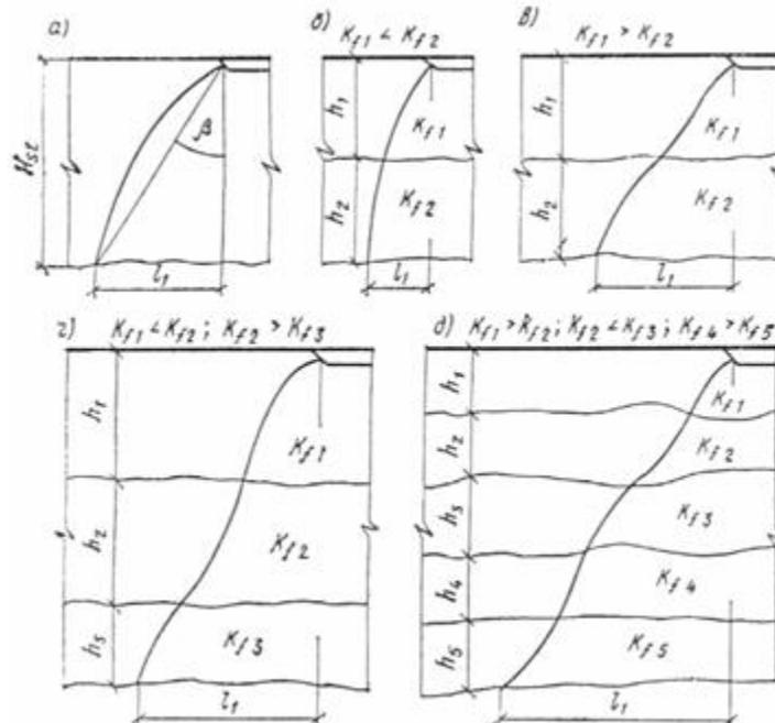
**Рис. 45. Схемы распространения увлажнения в стороны**
