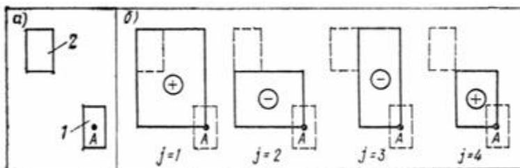
**Рис 15. (2 прил. 2). Схема к определению дополнительных вертикальных напряжений**
