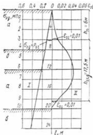
**Рис. 46. Схемы распределения напряжений от собственного веса грунта (I) и относительной просадочности (II) для расчета просадки грунта от собственного веса**
