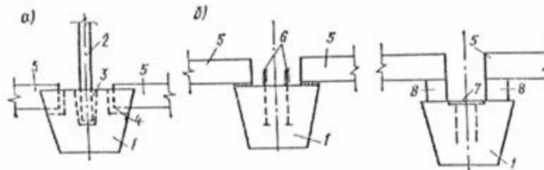
**Рис. 52. Сопряжение колонн с фундаментом**
