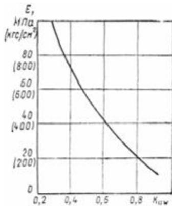
**Рис. 68. Зависимость модуля деформации от степени выветрелости**
