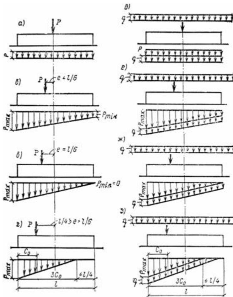
**Рис. 12. Эпюры давлений по подошве фундаментов при центральной и внецентренной нагрузках**
