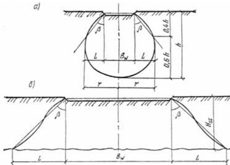
**Рис. 37.** Схемы увлажненных зон при замачивания грунтов
