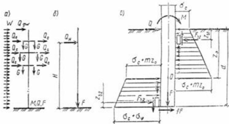
**Рис. 83. Схема к расчету стоек на опрокидывание**
