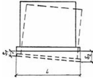
Рис. 7. Схема крена жесткого сооружения
