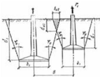
**Рис. 79.** Схема к расчету устойчивости при выдергивании
