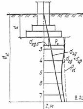
**Рис. 49. Расчетная схема распределения напряжений от собственного веса грунта, дополнительного напряжения и начального просадочного давления по глубине в основании фундамента**
