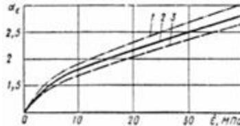
**Рис. 24. Пример зависимости предельных значений степени изменчивости сжимаемости основания от среднего значения модуля деформации грунтов основания в пределах плана здания**
