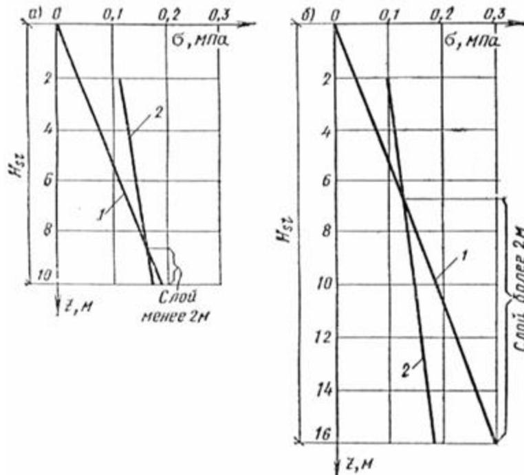
**Рис. 38. Пример определения типа» грунтовых условий по изменению напряжения от собственного веса грунта (1) и начального просадочного давления (2) по глубине просадочной толщи;**
