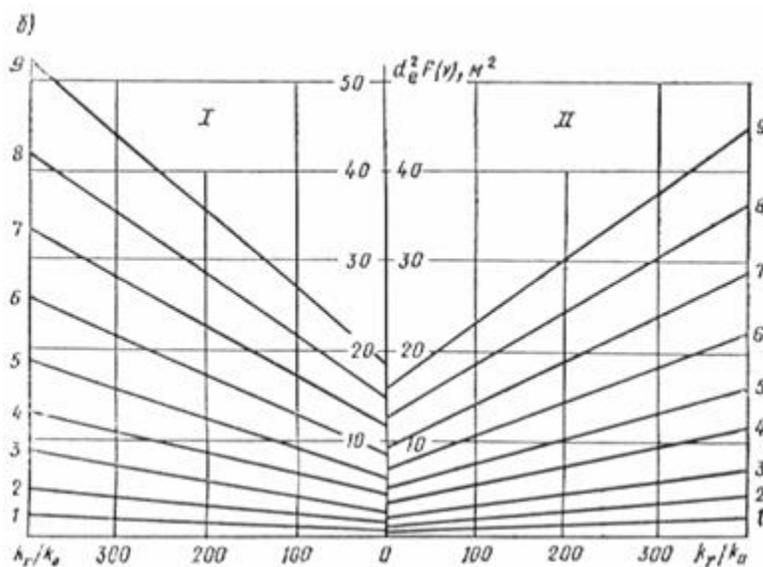
Рис. 65. Графики для определения шага пластмассовых дрен при мгновенном приложении уплотняющей нагрузки. Схемы расположения дрен
