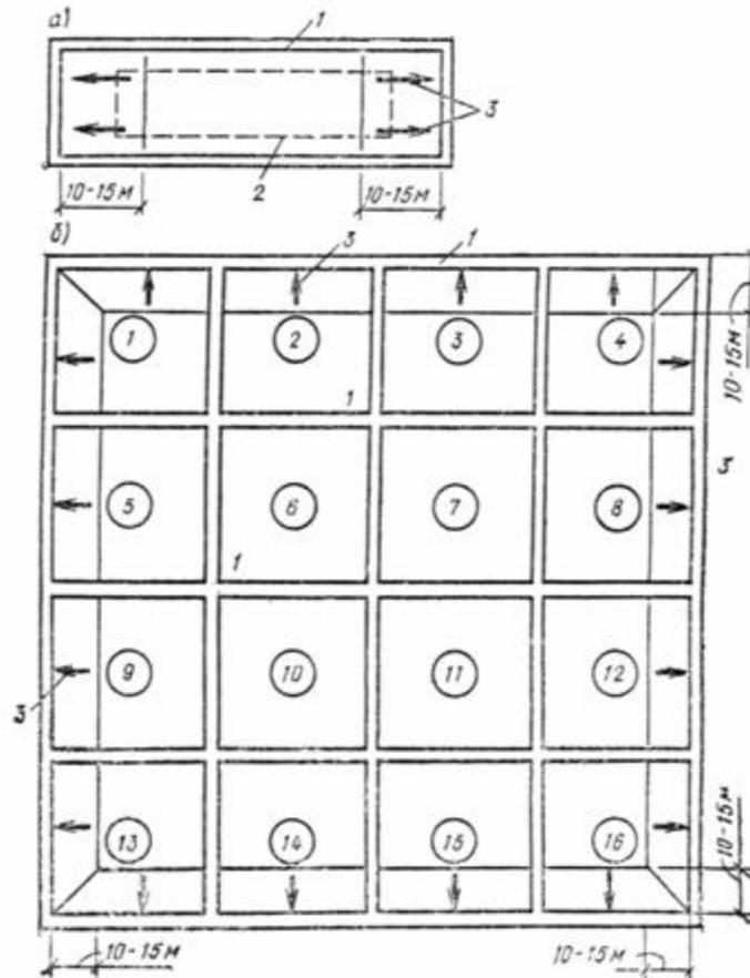
**Рис. 58. Схема планировки котлованов и карт для замачивания**
