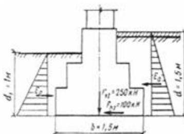
**Рис. 31. Расчетная схема к примеру расчета фундамента на плоский сдвиг по подошве**
