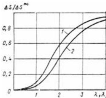
**Рис. 25. Соотношение между неравномерностью осадок, вычисленной с учетом и без учета жесткости здания ( и ) в зависимости от показателя гибкости: - всего здания длиной или - участка здания длиной (соответственно кривые 1 и 2)**
