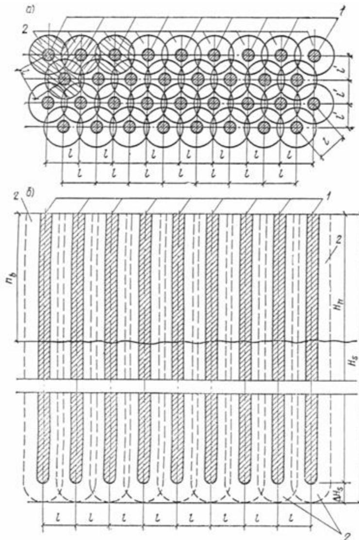
**Рис. 57. План расположения грунтовых свай (а)
