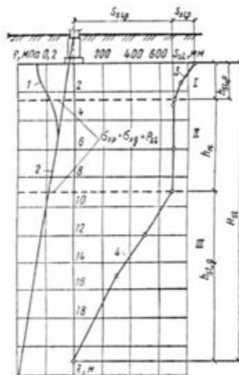
**Рис. 35. Зоны деформации просадочного грунта в основании фундамента**
