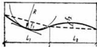
Рис. 8. Схема прогиба (выгиба) сооружения:
