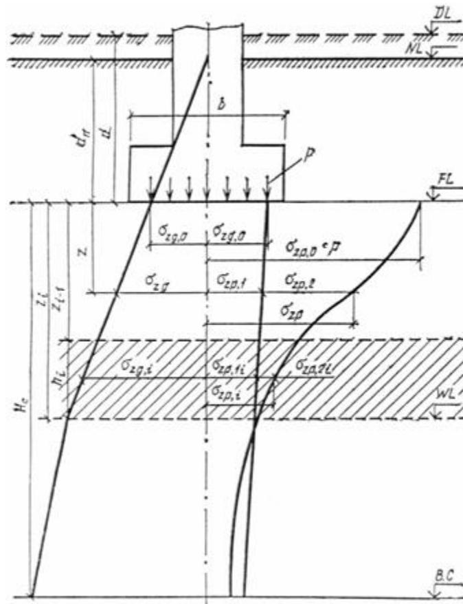
Рис. 19. Схема расчета осадки фундамент
