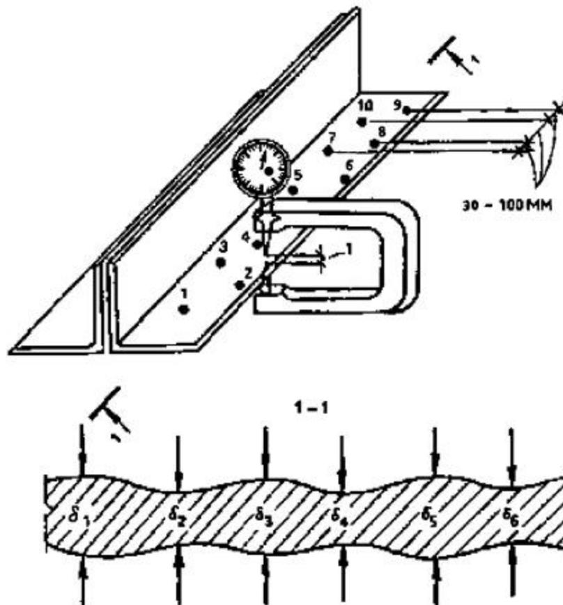
**Рис. 1. Схема измерения толщины элементов при сплошной коррозии**
