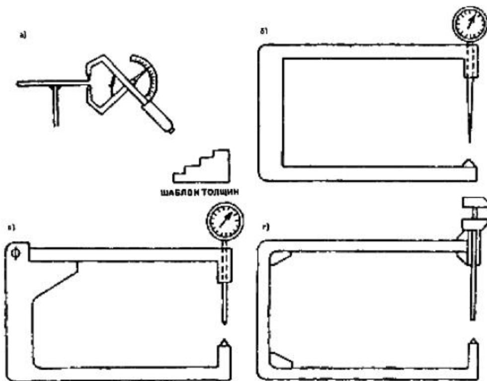
**Рис. 2. Инструменты для замеров толщины элементов**
